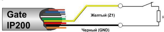
Рис.16. Подключение дверного контакта
