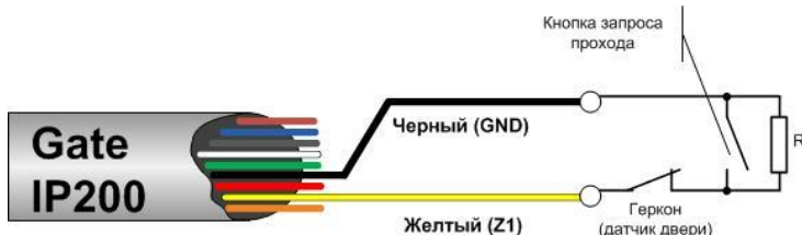
Рис.17. Подключение комбинированного шлейфа
